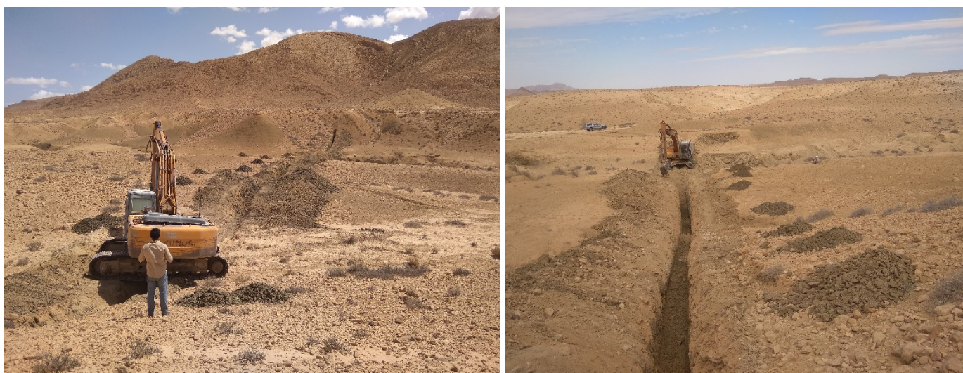
Figure 2- Travaux miniers : Exécution des tranchées minières, levé géologique et travaux d'échantillonnage.
