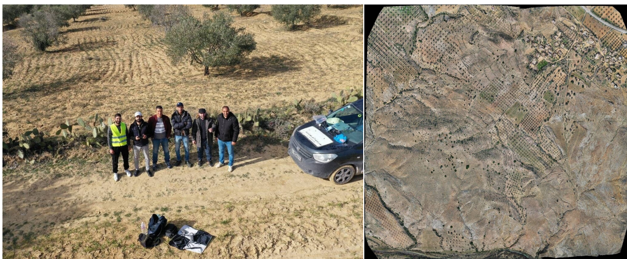
Figure 3 - Levés topographiques à 1/2000 par Drone sur le permis de recherche «Kaalat Bel Rhaoui».
